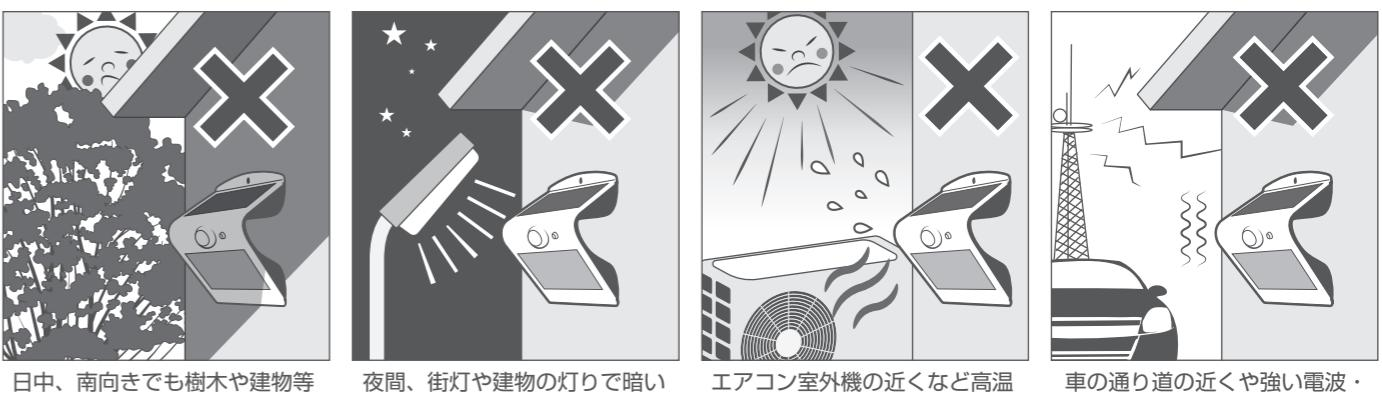
センサーは周囲の明るさと温度変化を検知するため、下図のような場所に取り付けると誤動作や動作しないことがあります。
