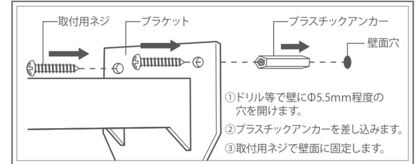
ブロック・煉瓦・コンクリート壁などに設置する場合は、コンクリートドリル等で壁に穴を開けます。その後、付属のプラスチックアンカーを差し込みブラケットを取付用ネジでしっかりと固定してください。
