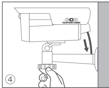
カメラの向きや角度を調整し接合部のネジをしっかりと締め固定します。ダミーケーブルをブラケットの穴に差し込みます。外れやすい場合は接着剤等で固定してください。
